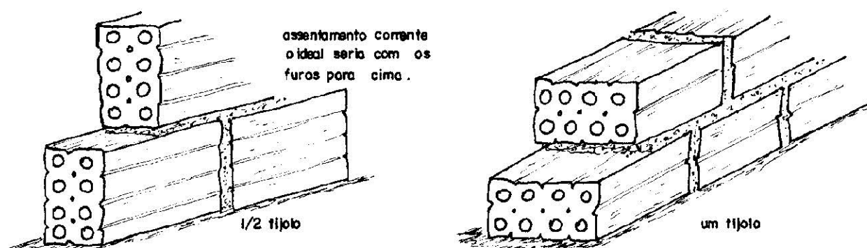
Figura 1 - Execução de alvenaria utilizando tijolos furados
